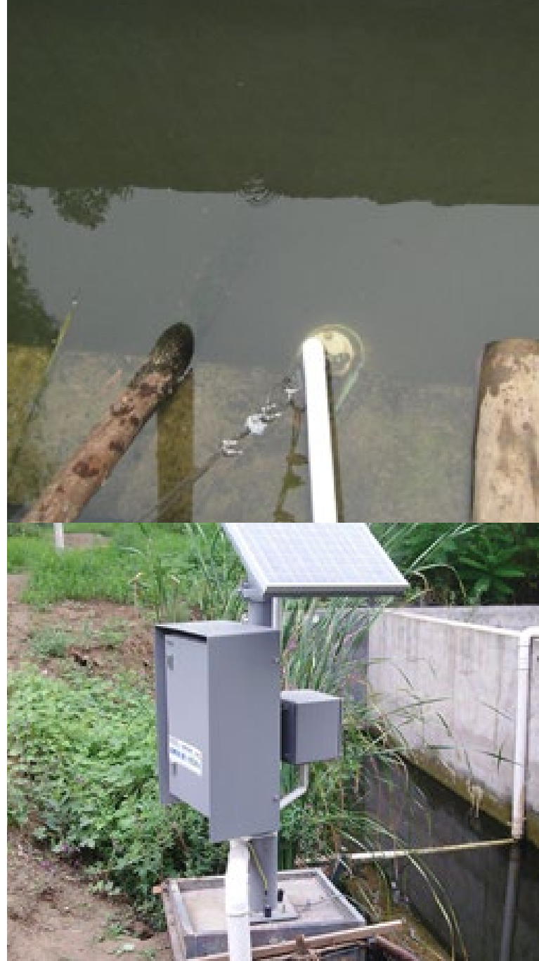
湿地进水口与出水口各安装一个，得出湿地水质净化结果。是湿地生化污染水质净化功能的重要指标。
