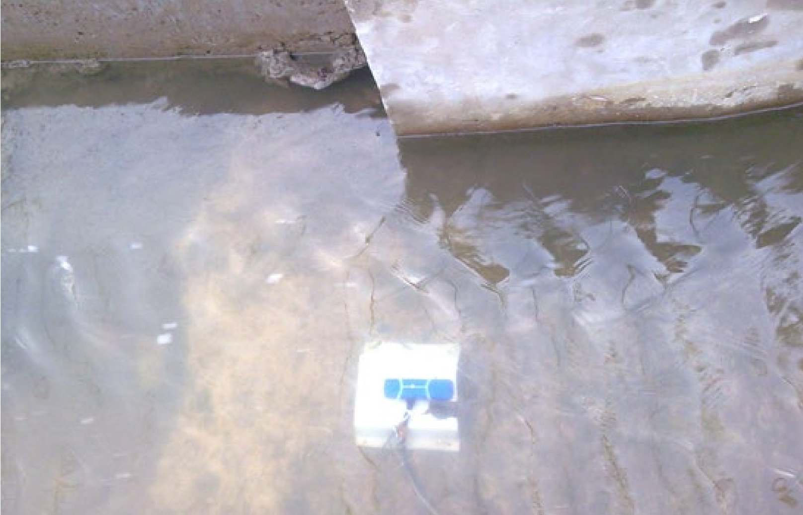
湿地进水口与出水口各安装一个，得出湿地流入水量、流出水量，监测湿地蓄水量变化。
