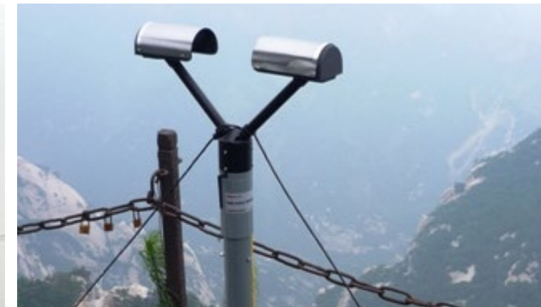
PS32-ZR（天气雷达 ZR 因子校准）
