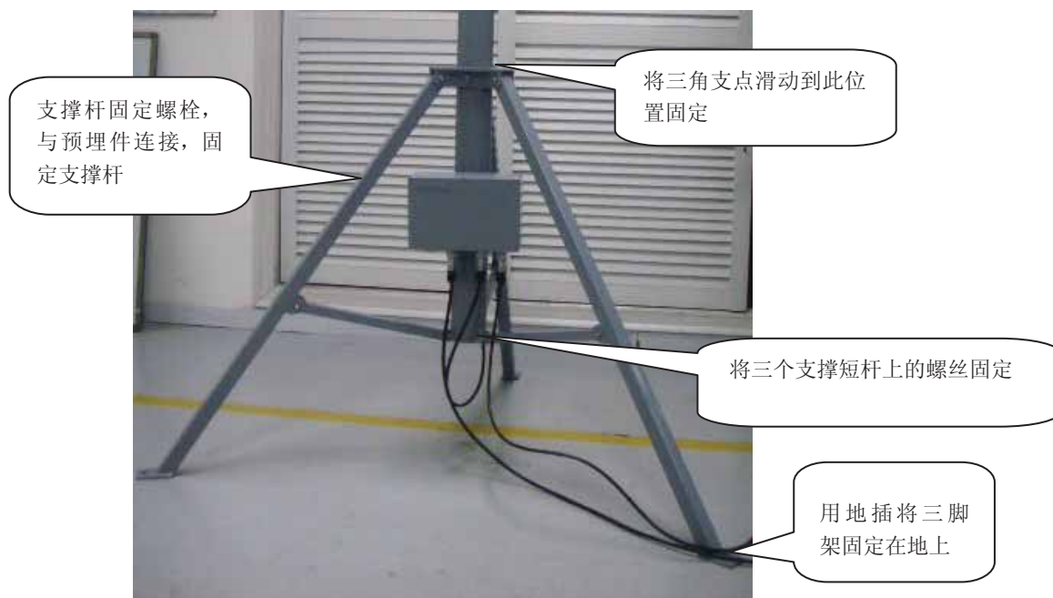
图1安装三角支架
